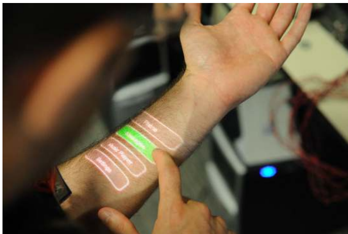
Abbildung 1.33: Skininput. In der Konzeptstudie „ Skininput “ wird die Haut als Interaktionsmedium genutzt. Hierbei wird ein Menü über einen mobilen Projektor auf die Haut projiziert und die Eingabe des Fingers über ein Feld von Vibrationssensoren am Oberarm detektiert.
