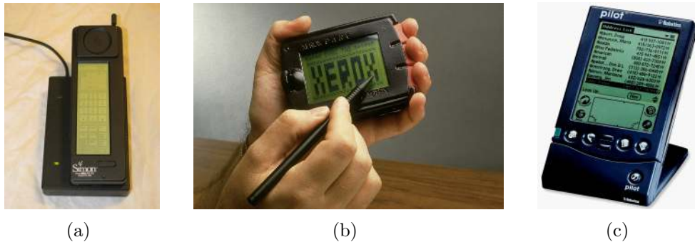
Abbildung 1.28: Beispiele für alternative Schnittstellen von mobilen Geräten. (a) IBM/BellSouth Simon (1993). (b) PARCTAB (1993). (c) Palm Pilot 1000 (1996).
