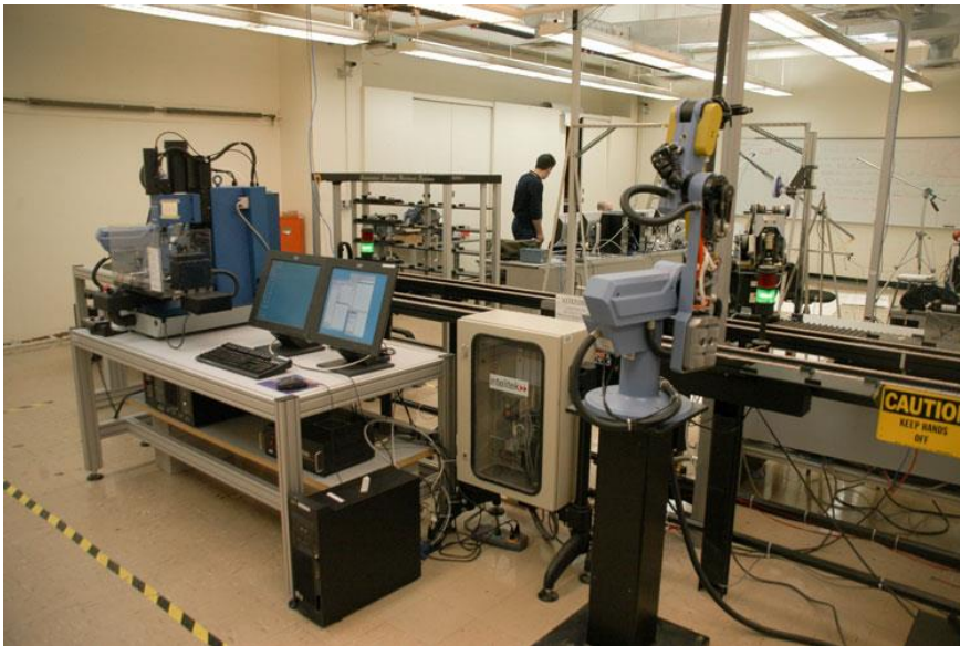
Abbildung 7: Beispiel für Computer Integrated Manufacturing – Fertigungsabläufe des Roboterarms werden vorab programmiert und können relativ leicht angepasst werden 8
